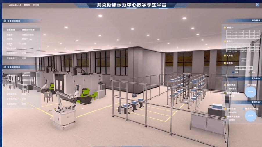
3D SCADA系统通过将人机界面中的场景和设备变成和现实场景中比例对应的3d场景和设备模型，并通过在后端系统中增加更多的点位状态信息采集来实现与现实设备一致的实时位置、姿态、状态渲染，能更加直观的显示每个设备的相关实时信息、区域设备组的业务执行信息以及整体场景的总统计信息。
